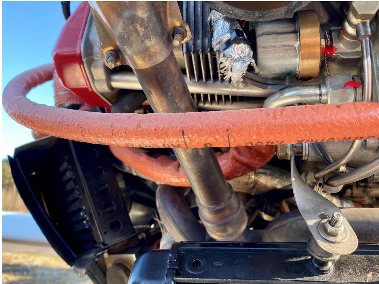
Her kan man se hvor trangt det er med denne slangeføringen.
