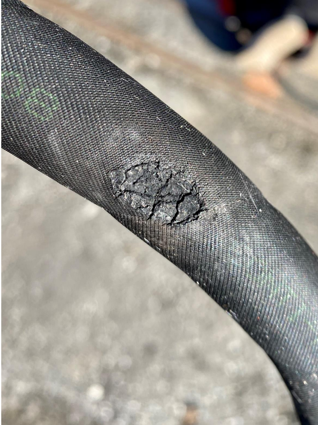
Oljeslange etter demontering med skade.
