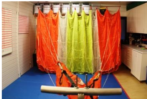
Figur 4: Inspeksjon av liner
