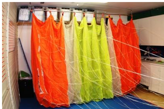
Figur 1: Oppheng for inspeksjon av skjerm
