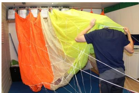
Figur 3: Inspeksjon av ribber og crossports
