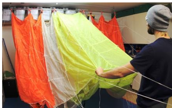
Figur 2: Inspeksjon av bunnduk
