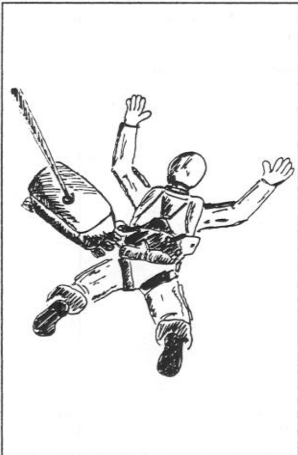
Fig 3. Pilotskjermen sluppet, pilotbåndet stramt.
