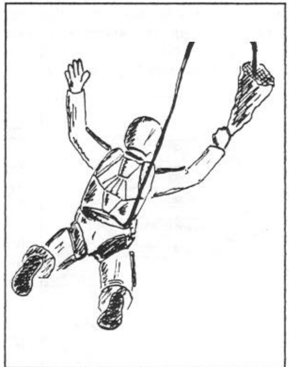
Fig 4. Pilotbåndet er stramt, pinnen trukket ut av låseløkken og bagen ute. Skjermåpningen begynner.
